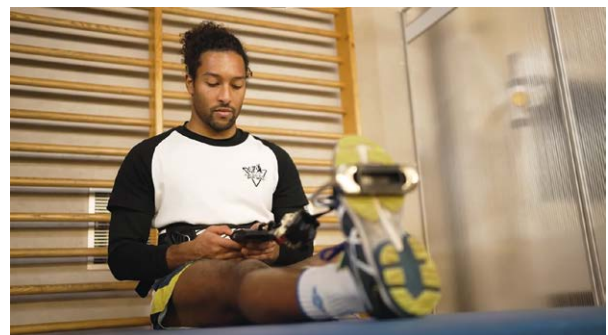
Abbildung 9: Isometrische Fußstreckungen in einem mobilen Trainingssystem bestehend aus Steigbügel, Spanngurt, Lastenwaage und Hüfttrapez.
